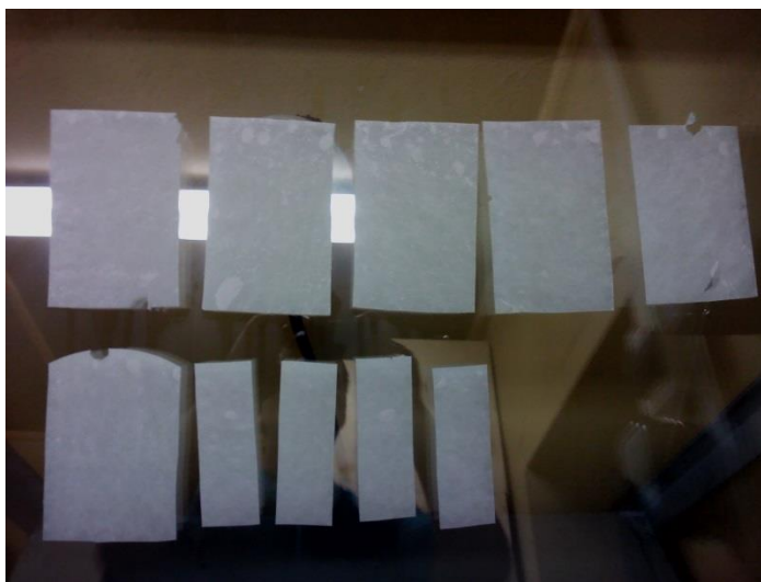
Контроль пористости методом паст на пробке и методом наложения фильтровальной бумаги на образцах-свидетелях
