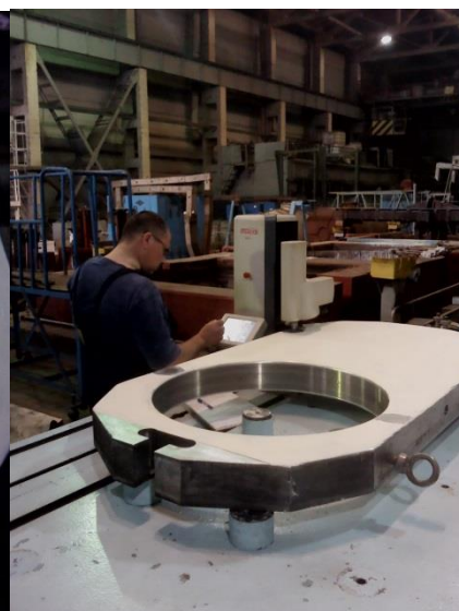
Контроль микротвердости на шибере. Прибор DuraScan.
