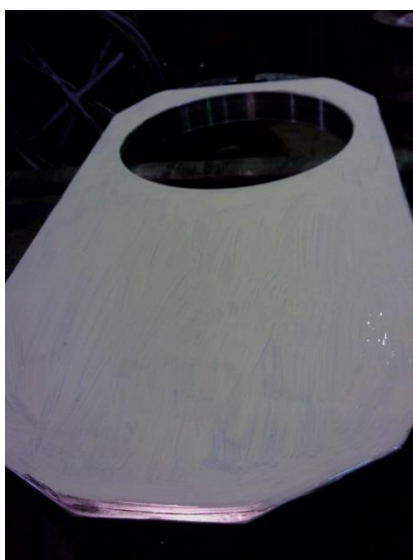
Контроль пористости по всей поверхности методом паст по ГОСТ 9.302-88
